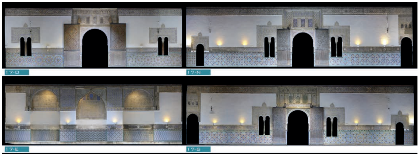
Figura 15. Ortofotos de los paramentos del Patio de las Doncellas, resultado del levantamiento fotogramétrico.
