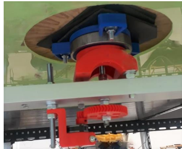
Figura 9. Sistema mecánico de plataforma giratoria
