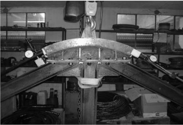
Foto 1.- Silla de desvío del ensayo de transmisión.
