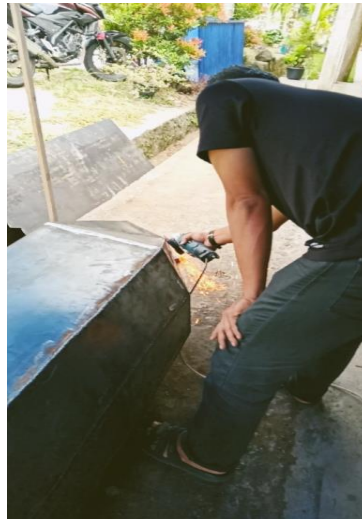
Gambar 6. Pembersihan hasil Pengelasan
