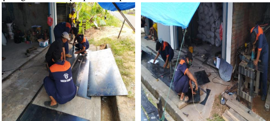
Gambar 3. Proses Pemotongan pola pada pelat
