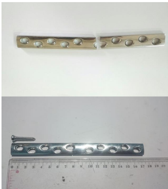
Gambar 1. Pelat terjadi patah saat proses penyembuhan tulang pasien
