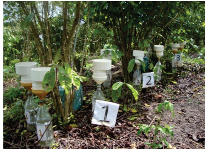
Figura 2. Interceptômetros utilizados para quantificação da precipitação interna
