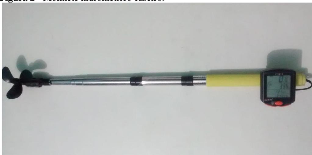
A calibração do molinete foi realizada no Laboratório de Hidráulica da Faculdade Araguaia, onde foi utilizado um canal de escoamento hidráulico de forma retangular (Figura 3) modelo STT 507, cuja vazão foi calculada, através da equação 1, com a
