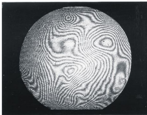
Рисунок 3 – Интерферограмма пластины, имеющей несферическую форму изгиба
