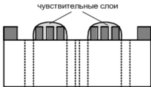
Рисунок 4 – Поперечное сечение микросистемы после нанесения чувствительного слоя и его термообработки
