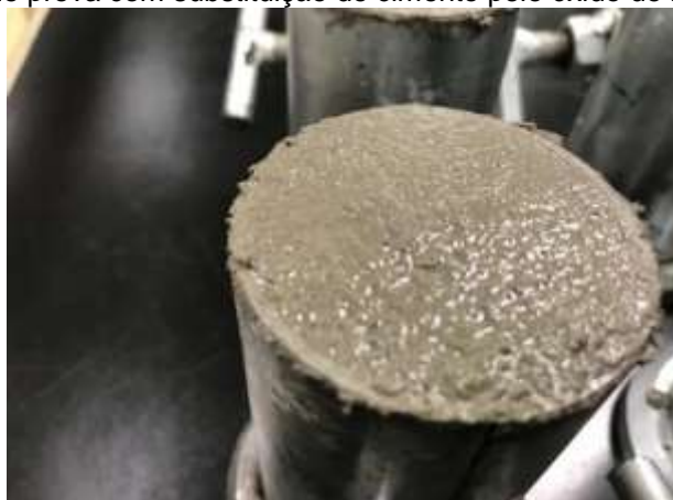
Figura 3 - Corpo de prova com substituição de cimento pelo óxido de nióbio(V) hidratado.
