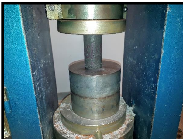
Figura 3: Corpo de prova sendo ensaiado axialmente para determinação da resistência.
