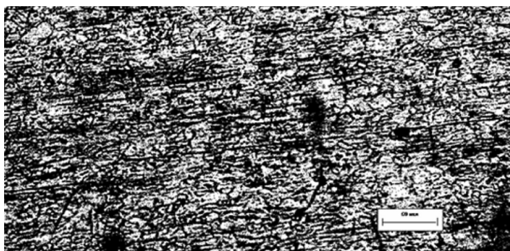
Рис. 4. Микроструктура сплава ЗлСрМ 900-40 после прокатки полосы исходной толщины 4 мм до толщины 0,55 мм (степень деформации составляет 86,3 %)
