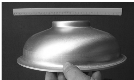
Рис. 12. Внешний вид деталей типа «полукамера», являющихся составными частями резонатора ускорителя электронов, изготовленных из особо чистого ниобия в лаборатории высоких давлений ФТИ гидроударной штамповкой
