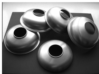
Рис. 12. Внешний вид деталей типа «полукамера», являющихся составными частями резонатора ускорителя электронов, изготовленных из особо чистого ниобия в лаборатории высоких давлений ФТИ гидроударной штамповкой
