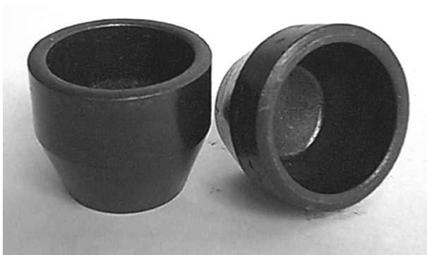
Рис. 4. Изображения детали «корпус сверлильного патрона» из ковкого чугуна, полученной методом обратного выдавливания из цельной цилиндрической заготовки за один проход
