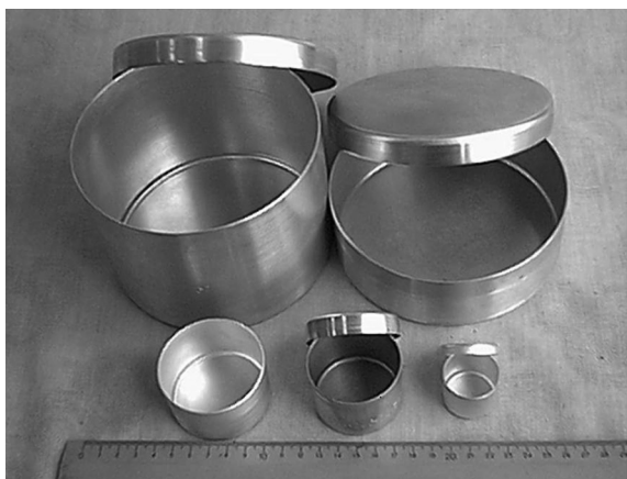
Рис. 9. Лабораторные стаканчики для строительных, химических, геофизических лабораторий, изготовленные в лаборатории высоких давлений ФТИ с использованием гидроударной штамповки
