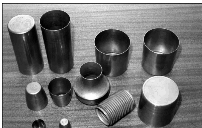
Рис. 8. Образцы тиглей из платины (применяются в цементной промышленности, нефтехимии, производстве стекловолокна), изготовленные в лаборатории высоких давлений ФТИ с использованием гидроударной штамповки
