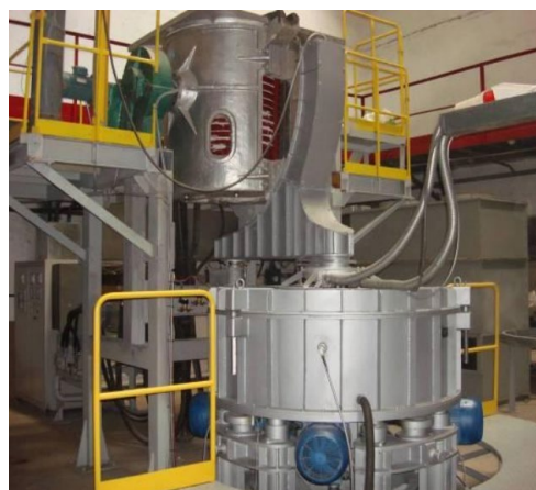
Рис. 2. Опытный образец промышленной установки для получения заготовок массой 200 кг
