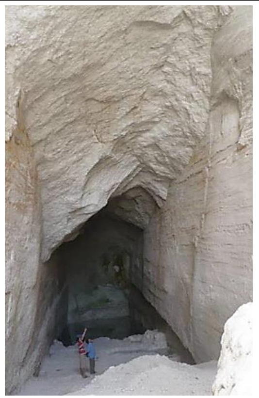
Figura 3 – Mina subterrânea de caulim realizada, parte com escavação manual, parte mecanizada, na localidade Alto do chorão, no município de Junco do Seridó-PB.
