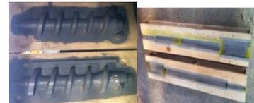
Gambar 8. Mal *Screw Press* dan Kotak Inti
