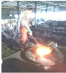
Gambar 11. Proses Peleburan dengan Tanur Induksi
