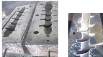
Gambar 10. Cetakan *Screw Press*
