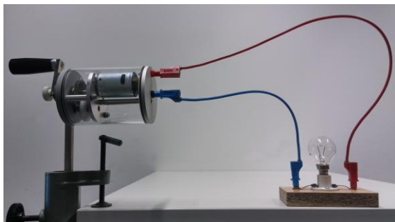
Abb. 2: Erfahrbare Energieübertragung mit Hilfe des handgetriebenen Generators „DynaMot“ nach Muckenfuß und einer 30 W Lampe.
