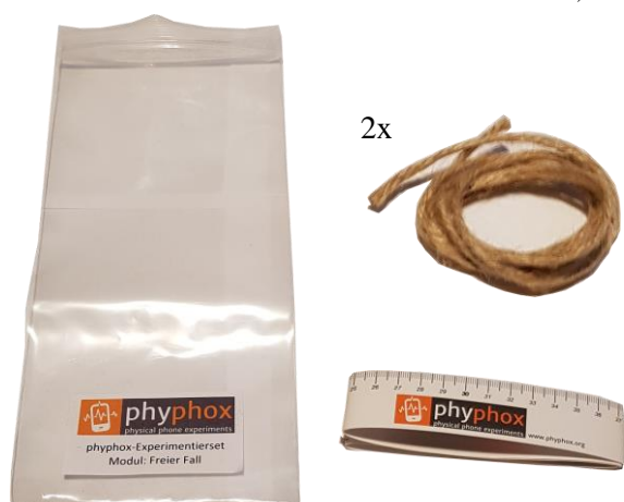
Abb. 1: Darstellung des Experimentiersets zum Versuch Fadenpendel. Im Experimentierset sind ein Druckverschlussbeutel, der gleichzeitig auch als Smartphone-Halterung dient, zwei Fäden mit einer Länge von einem Meter und in der Weiterentwicklung nach der Befragung der Studierenden auch ein Maßband enthalten.
