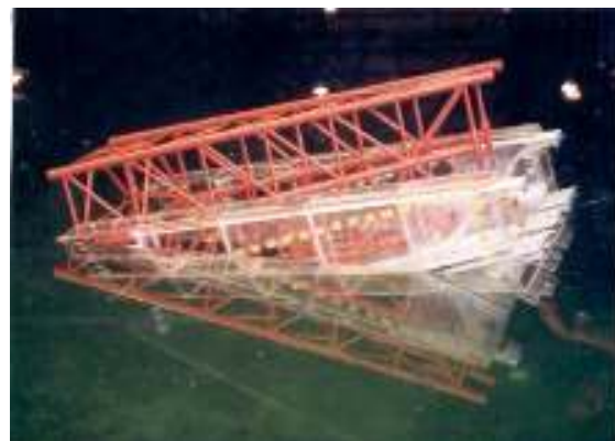
Gambar 5. Model tongkang “ALPO” tahun 2006 di kolam uji BTH – BPPT
