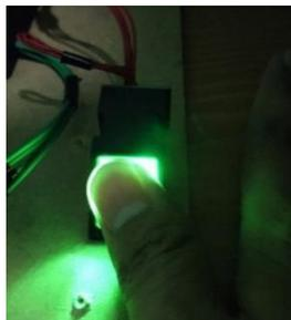
Gambar 8. Pengujian Sensor Sidik Jari
