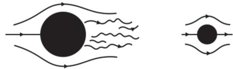
図5 小さな物体を回り込む流れは整っており(層流)、大きな物体とは大きく異なる
