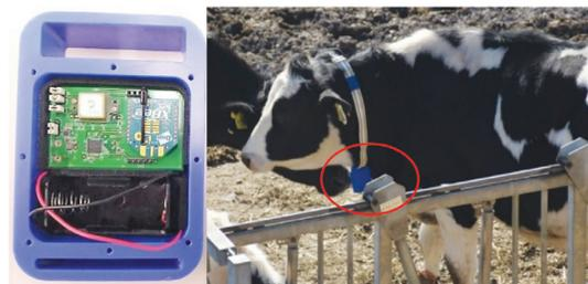
写真3 開発した活動量センサと牛に装着時の様子
