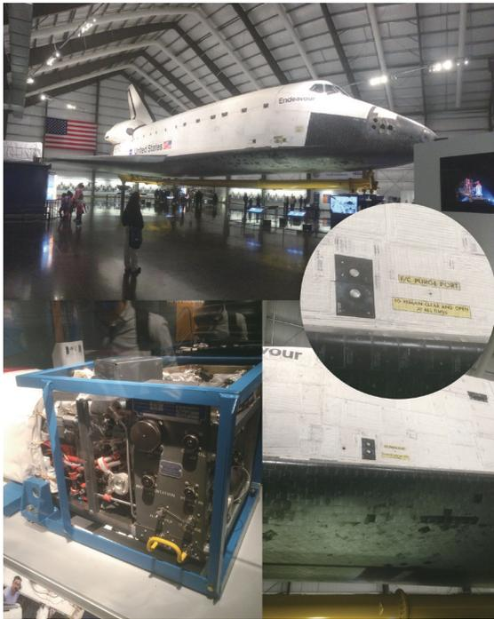
写真1 (上) スペースシャトル・エンデバー号, (左下) 搭載されていた燃料電池, (右下) 燃料電池 (FC) のガスバージのためのポート
