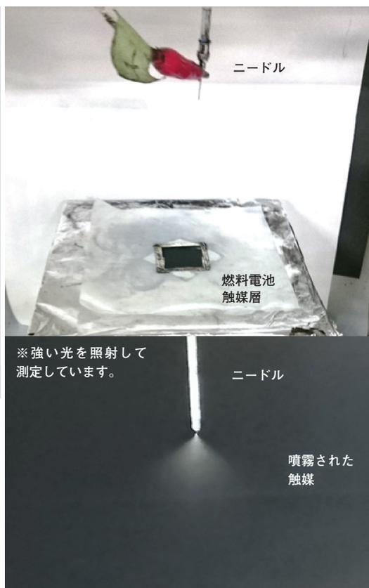
写真5 静電噴霧法による固体高分子形燃料電池の触媒層の形成
