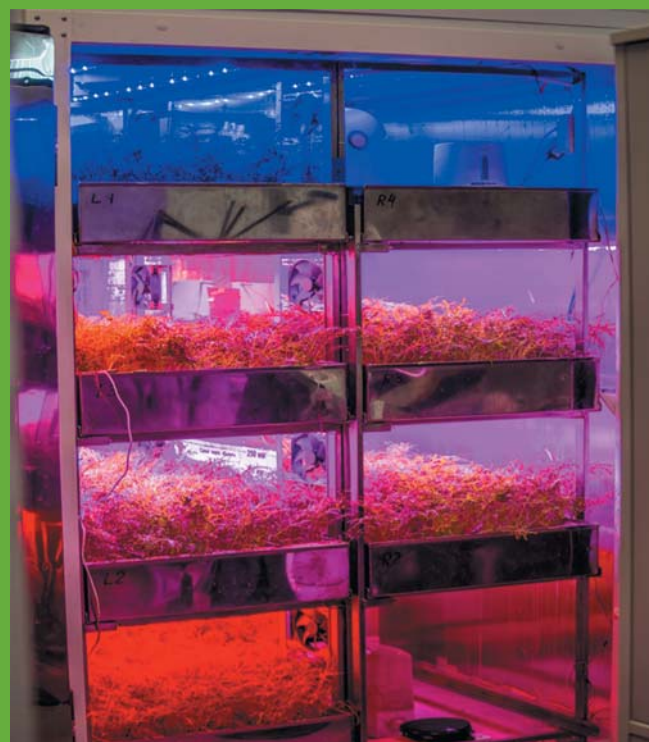
Рис. 7. Выращивание салата-латука в экспериментальном синерготроне модели ИСП-1.01 при освещении светодиодами красного и синего света (2018 год)
