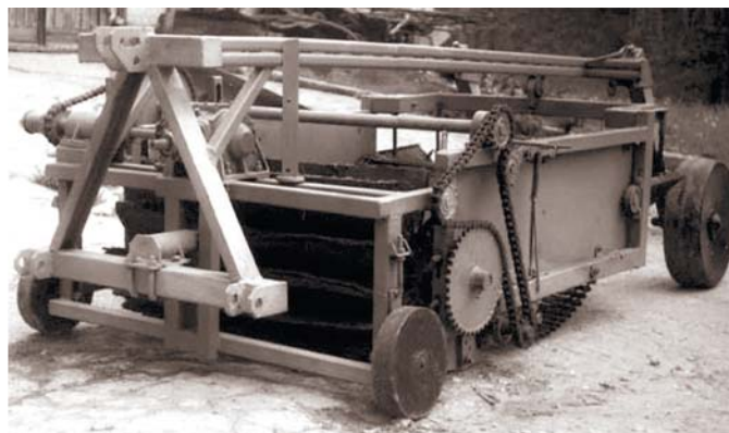
Рис. 10. Общий вид копателя лука КЛР-1,4Ш (выкапывающее устройство патент РФ 2240671) Fig. 10. General view of the onion digger KLR-1.4Sh
