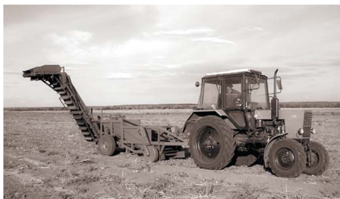
Рис. 11. Лукоуборочная машина ППЛ-0,8В (патент РФ 2240673) Fig. 11. Onion harvesting machine PPL-0.8V
