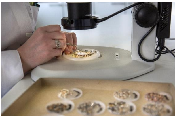
Figur 5: Ved selve fingrussorteringen benyttes et stereomikroskop der forstørker kornene, således at det er lettere at genkende de forskellige gruppers karakteristika. (Lars Kruse, AU foto)
