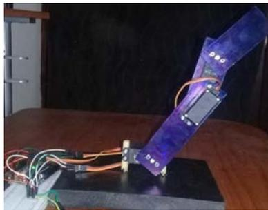
Figura 10 Sistema de brazo robótico imitador de 3g.d.l.
