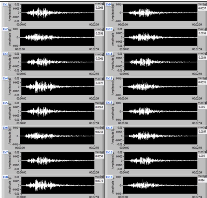
Figura 5.33 - Serie temporali registrate dal sistema di monitoraggio durante l'evento del 30 Ottobre 2016 con epicentro in Norcia.
