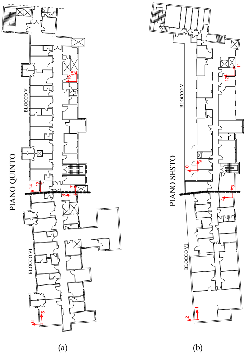
Figura 5.6 - Layout sistema di monitoraggio: quinto (a) e sesto piano (b).
