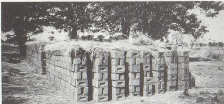
Lufttrocknung der gepressten Lehmsteine
