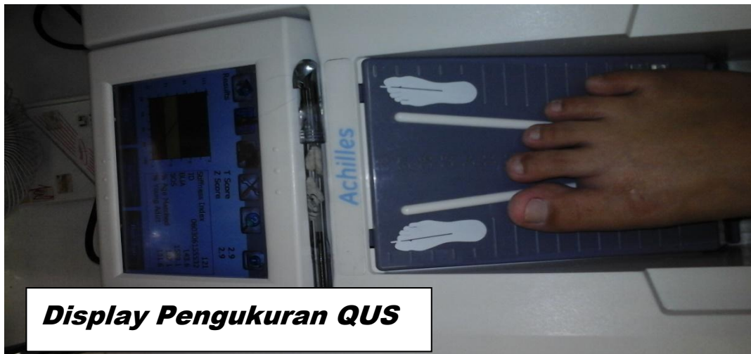
Gambar 1. Pengukuran QUS sampel Tumit Kaki
