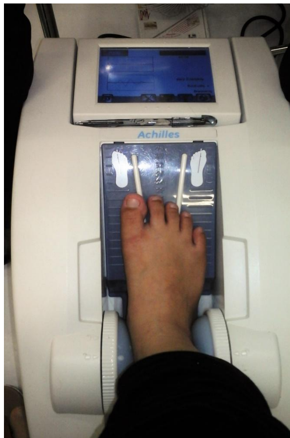
Gambar 2. PENGukuran QUS sampel Tumit Kaki Tampak Atas
