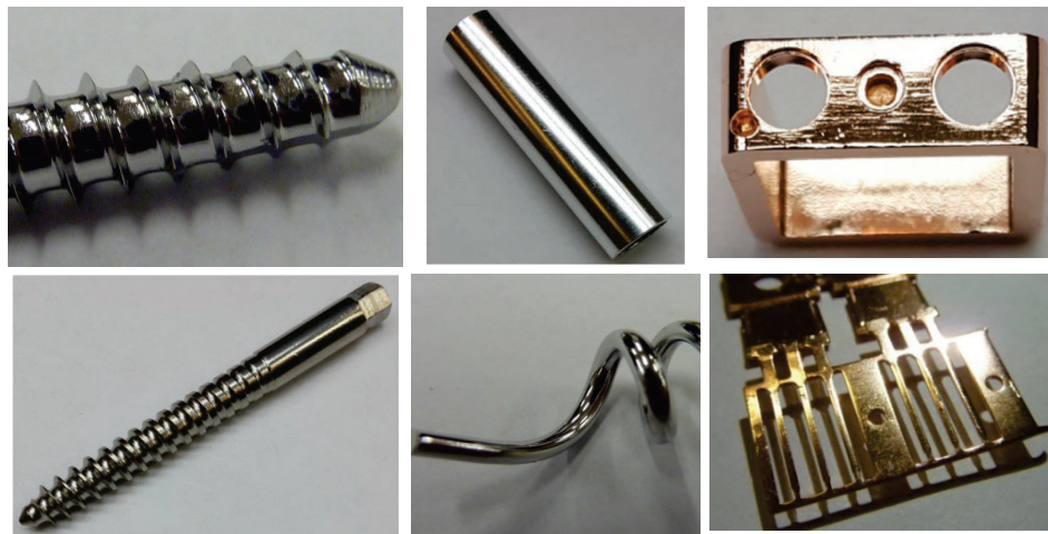
Рис. 8. Примеры импульсного электрохимического полирования образцов из различных металлических материалов с применением разработанного источника питания
