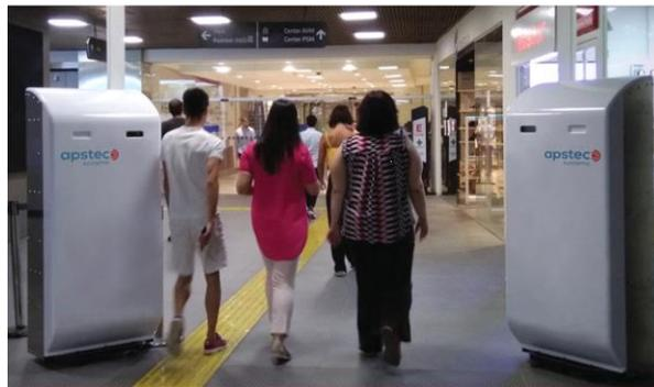
Рис. 1. Многопозиционная микроволновая досмотровая система в месте эксплуатации
