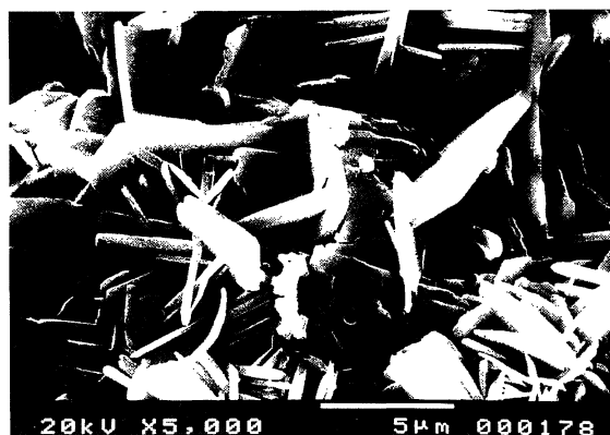
Figura 1.- Mortero MT1; a) antes de la exposición: presencia de cristales de calcita en la superficie; b) expuestos 6 meses: capa de yeso formada en la superficie de la muestra.
