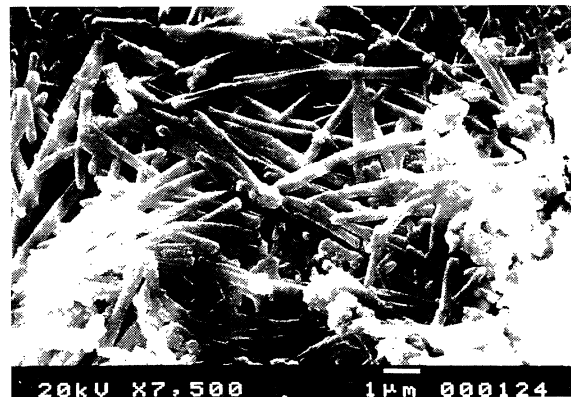
Figura 8.- Mortero MT4, 6 meses en la cámara. EDX y microfotografía de los cristales con forma de aguja; probablemente thaumasita y yeso.
