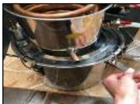
Figura 20-3: Aseguramiento de tanque de ebullición
