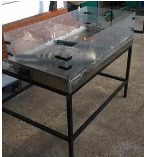
Figura 5-3. Montaje de la base del prototipo de pista de hielo
