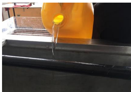
Figura 6-4. Preparación salmuera de Propilenglicol.
