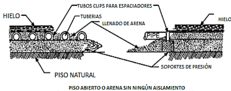
Figura 16-2. Piso abierto de arena sin aislamiento
