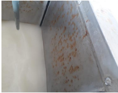
Figura 4-4. Oxidación en el tanque de salmuera
