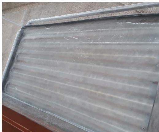
Figura 1-4. Formación del hielo Cloruro de Calcio 21%
