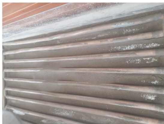
Figura 6-3. Montaje de serpentín y arena en el prototipo
