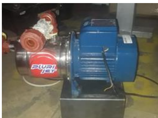
Figura 2-3. Bomba PREDOLLO PLURIJETm 4/100-N
