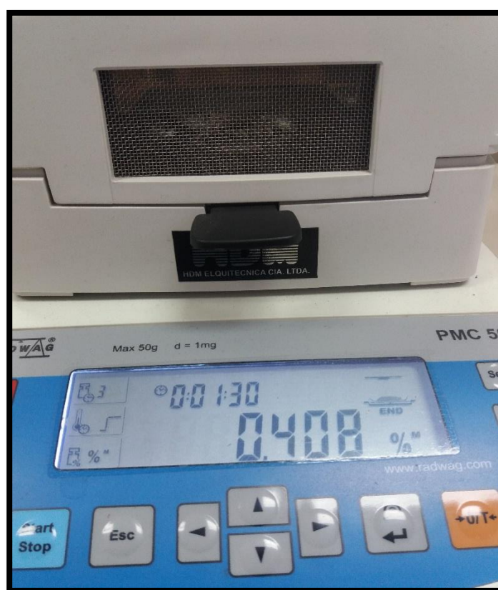
Figura 3-3. Análisis de humedad de la muestra de poliestireno Realizado por: Núñez Nelson, 2019
