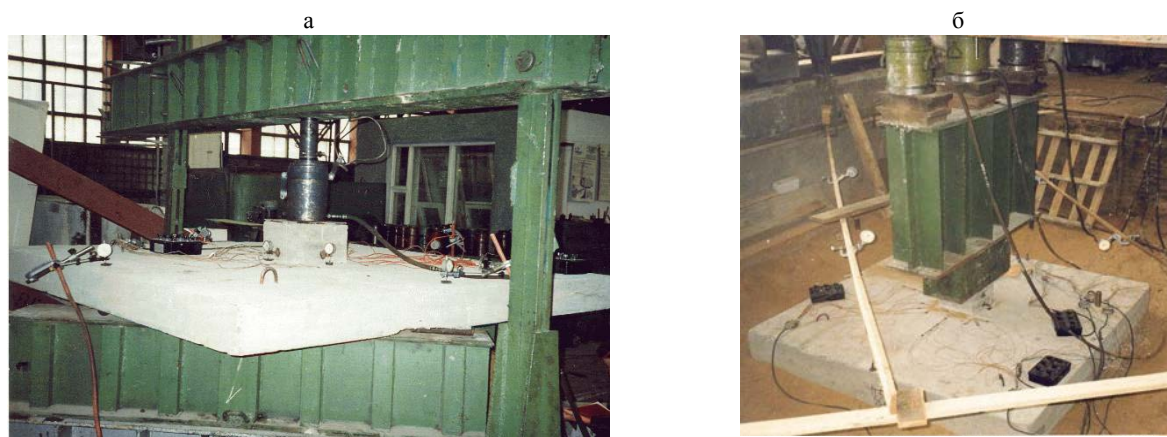
Рис. 2. Общий вид испытания плит: а – при опирании на точечные опоры; б – то же на грунт
