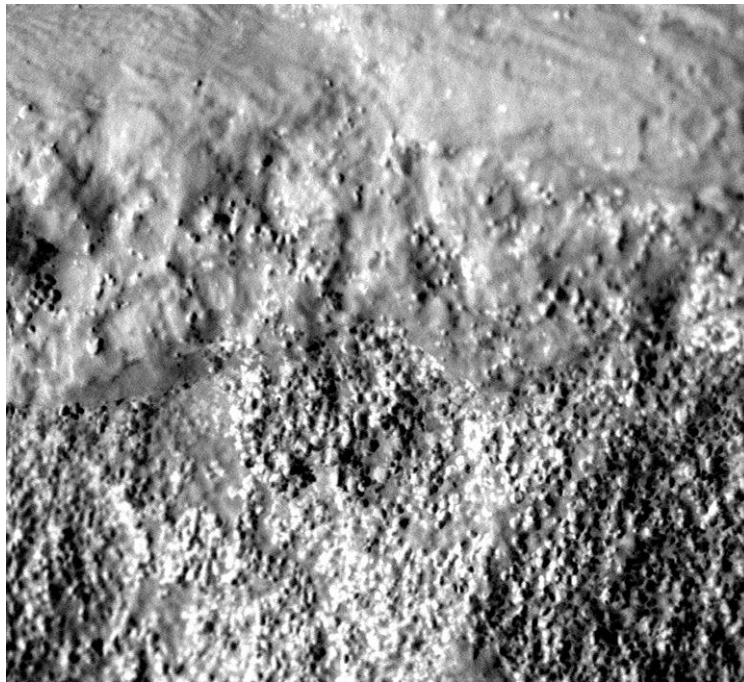
Gambar 5. Struktur mikro permukaan komposit HA tanpa kalsinasi pada tekanan kompaksi 100 kg/cm 2
