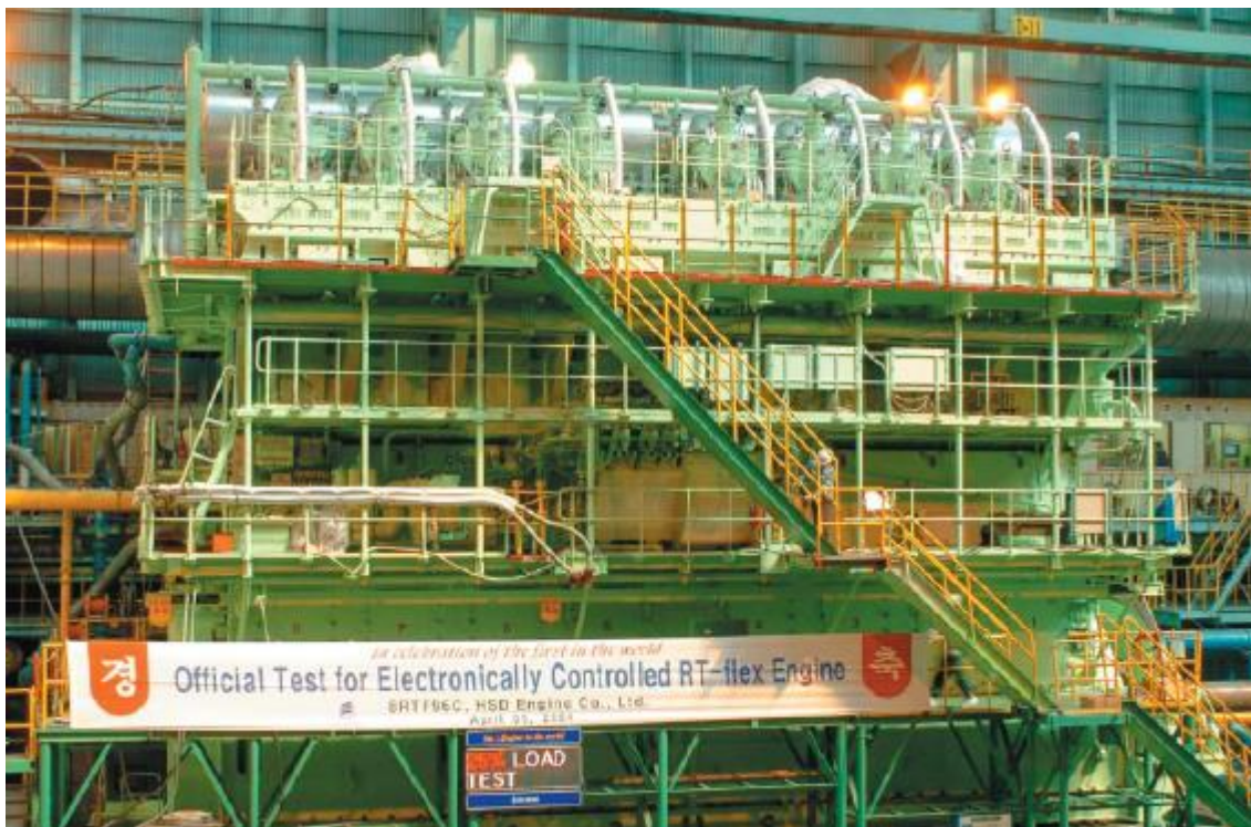
Slika 9. Prvi Sulzer RT-flex96C motor[17]
