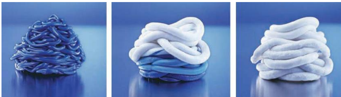
Slika 21. Utjecaj aditiva na promjenu boje u cilindru [7]
