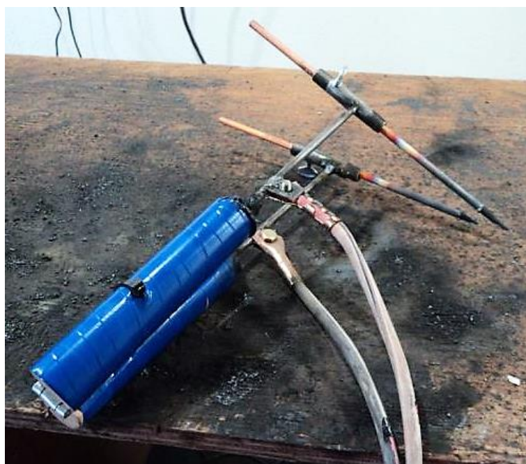
Slika 18. Pribor za elektrolučno lemljenje (Izvor: Matušin, 2016.)
