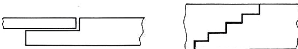
Slika 9. Postupni spoj (Izvor: Garašić, 2012.)
