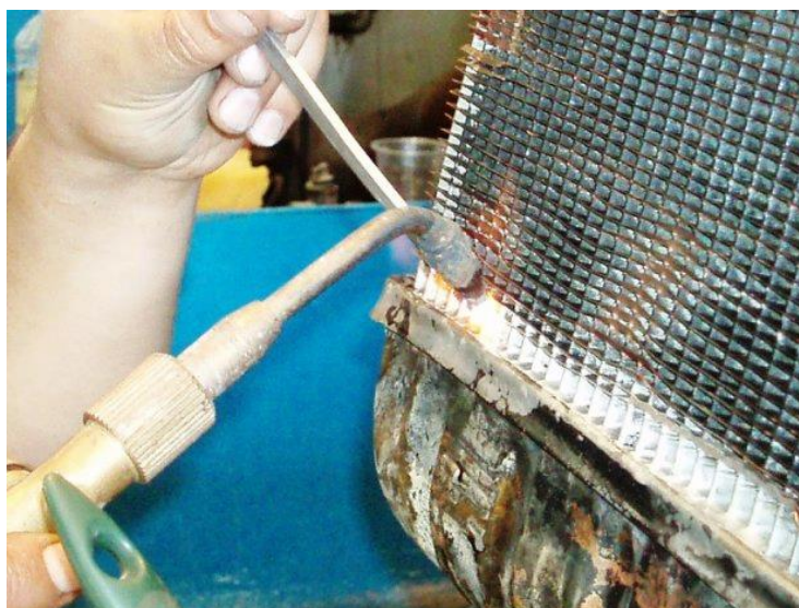
Slika 26. Popravak rashladnog bloka hladnjaka plinskim lemljenjem (Izvor: https://karosserie-birgmann.de/kuehlerinstandsetzung/ )
