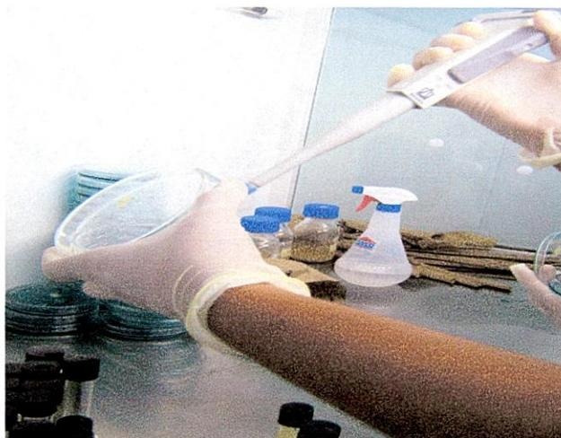
Figura 12. Micropipeta para la siembra superficial de las diluciones en el agar MRS.
