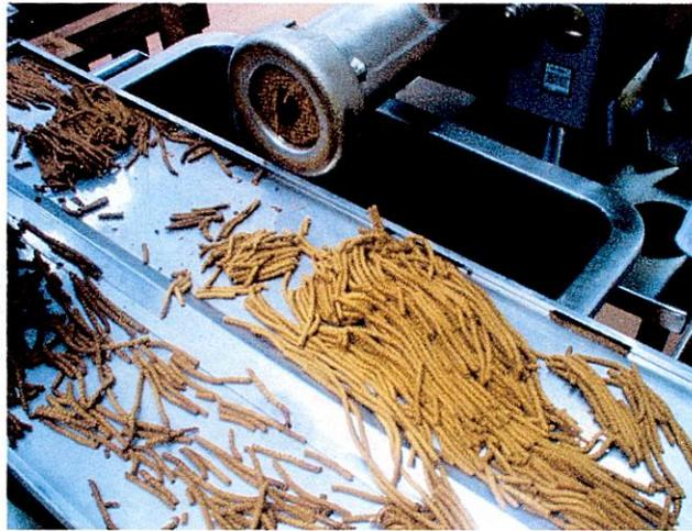
Figura 5. Obtención de tirillas de alimento concentrado ya homogenizado con ayuda de un molino eléctrico.
