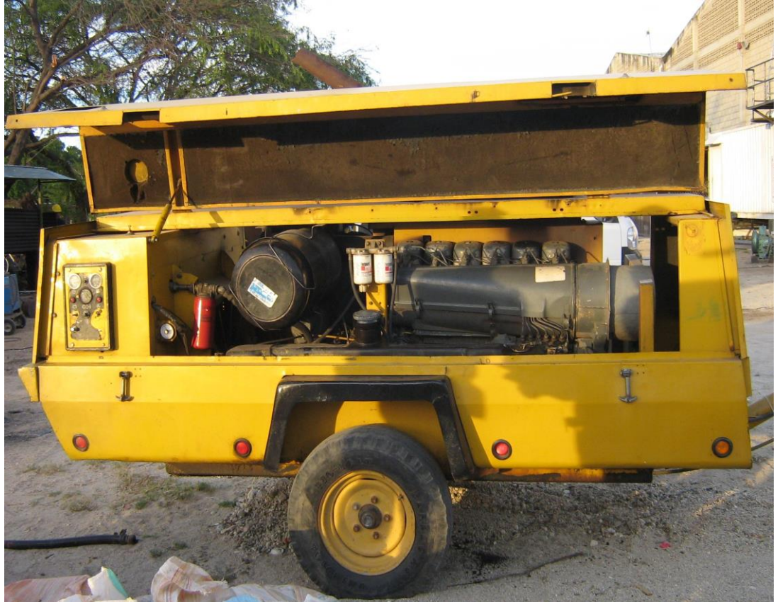
Anexo 8. Motor compresor Atlas copco XAZ-750, foto 1
