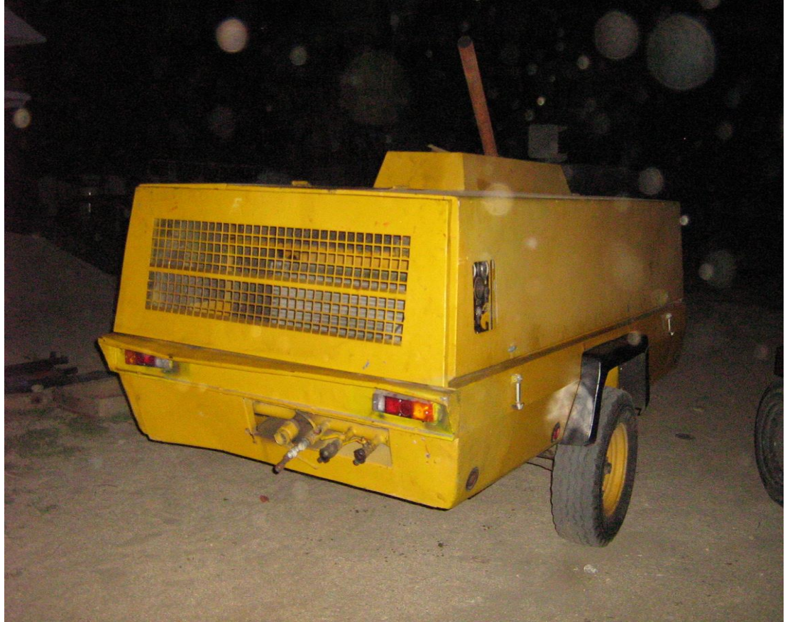
Anexo 9. Motor compresor Atlas Copco XAZ-750, Foto 2
