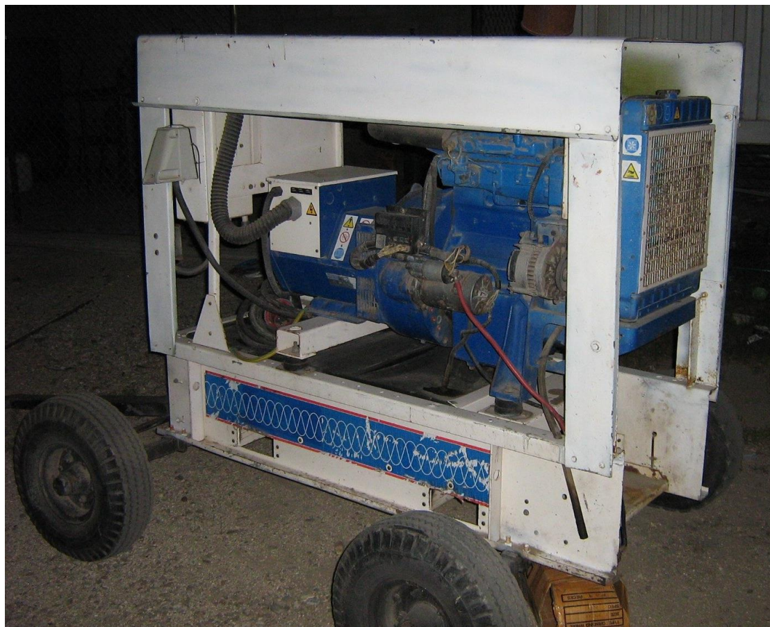
Anexo 6. Planta eléctrica FG Wilson PJ30, 23 KW, cod. GE0201, foto 1
