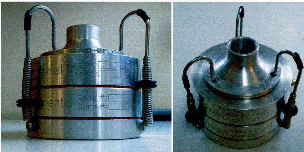
**Figura 19. Impactador de Cascada Marca Tisch Environmental de 2 etapas**
