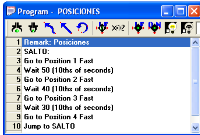
Figura 3.10.4. Temporizaciones entre las 4 posiciones 48 .
