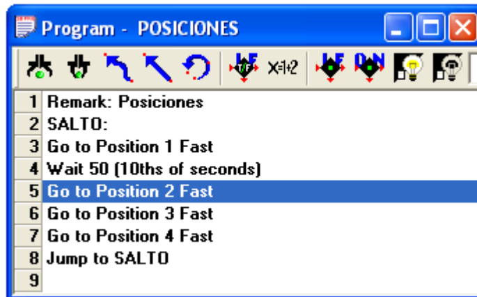
Figura 3.10.3. Temporización de 5 segundos entre la posición 1 y 2 47 .
