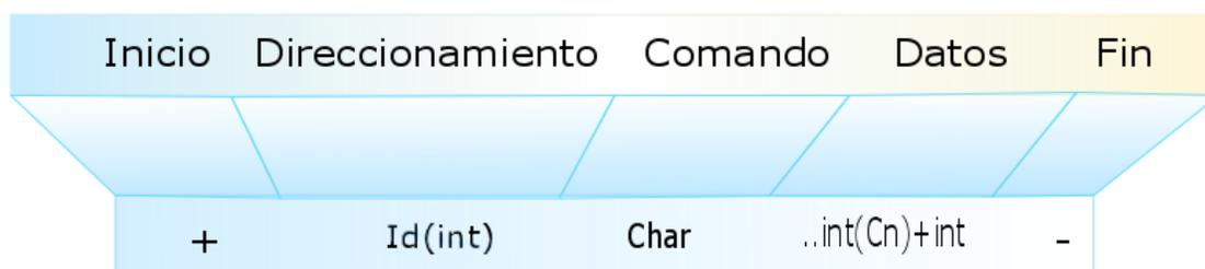
**Figura 25** Ilustración 1 trama de datos para la comunicación serial entre el raspberry y el arduino.
