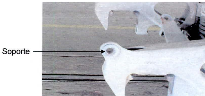
Foto 47. Soporte para cadena en truques de 40 Tons.
