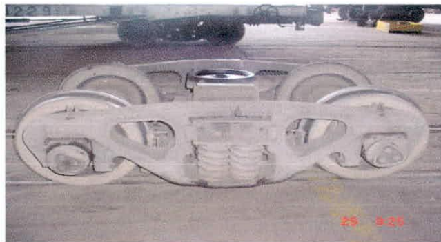
Foto 38. Bastidores semi-integrales o estabilizados
