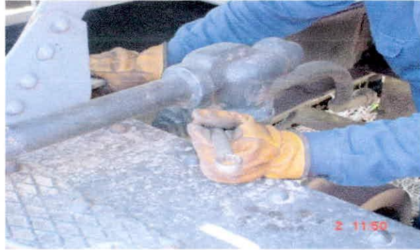
Foto 141. Llave de 3/4" para retirar recipiente de impurezas
