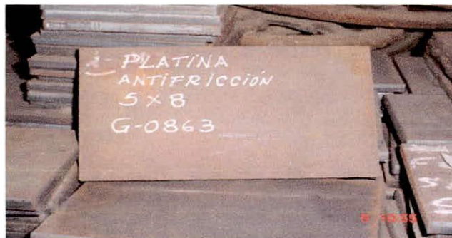
Foto 42. Platina colocada para truques de 35 ton.
