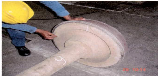
Foto 16. Medición en 4 puntos de la rueda.
