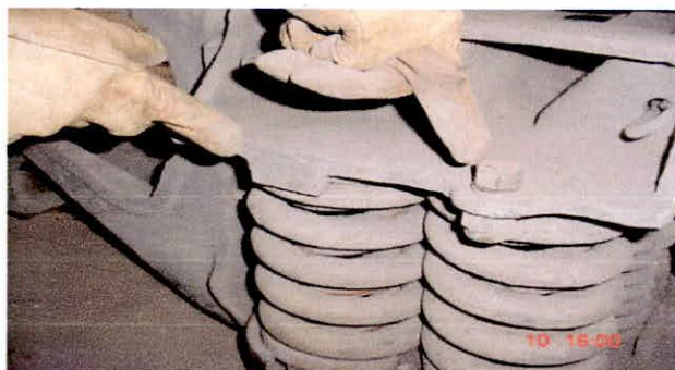
Foto 70. No presencia de tornillo y platina de seguridad en resorte
