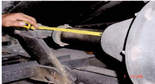
Foto 119. Medición de la carrera del vástago del cilindro de freno
