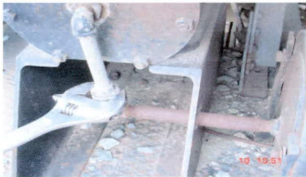
Foto 176. Soltar conexión al cilindro del freno
