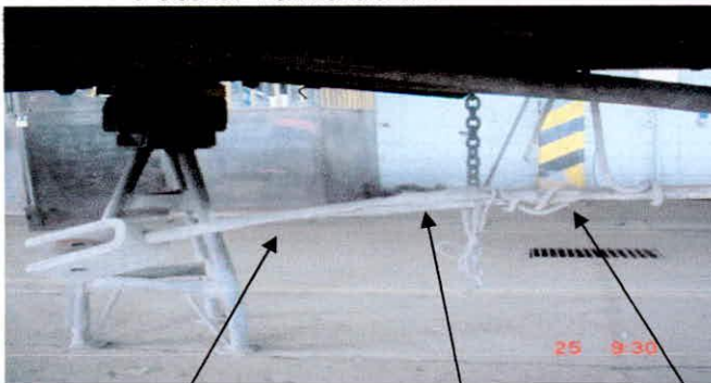
Foto 6. Varilla de tiro
