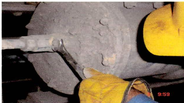
Foto 151. Afloje de tornillos de la parte trasera del cilindro
