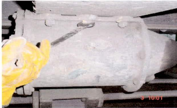
Foto 152. Retiro de tornillos que aseguran el cilindro al soporte de la estructura del vehículo
