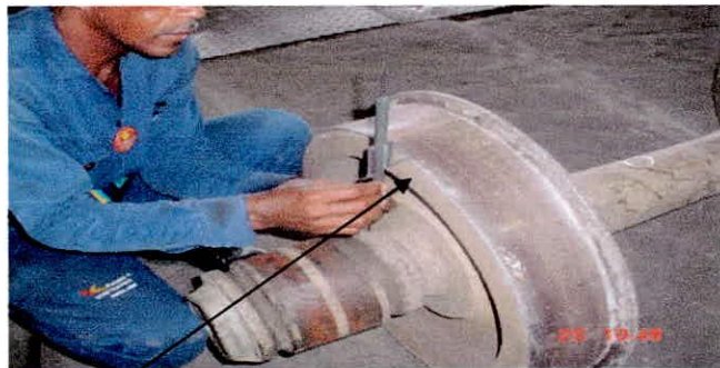
Foto 18. Espesor de la rueda Espesor De La Rueda
