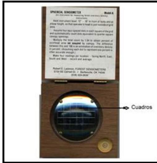
Figura 6. Densiómetro Forestal Cóncavo, utilizado para medir la densidad del dosel en las zonas del área de estudio. (terrages.pt)
