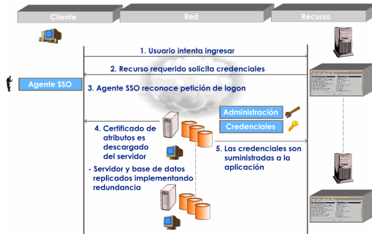
Figura 11. Admón. y almacenamiento de la Identidad centralizados garantizando alta disponibilidad y redundancia
