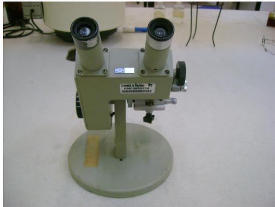
Este aparato está equipado con compensadores de luz, que eliminan las ondas no se requieren para medir la refracción.
