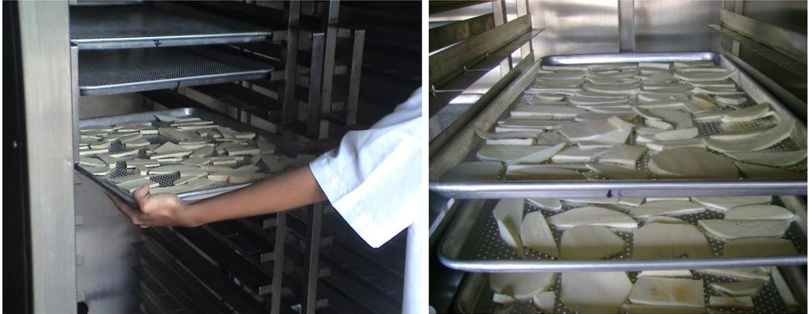
Las bandejas marcadas fueron llevadas al deshidratador a unas temperaturas entre 55°C-85°C en un lapso de 5 horas, Las frutas deshidratadas fueron colocadas en baldes plásticos limpios para ser pesadas.
